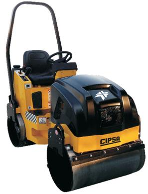
Este rodillo vibratorio doble posee un rediseño estético moderno, raspadores de rodillo mucho más durables, chasis delantero más angosto, saca sus rodillos hacia adelante y hacia atrás; además el diseño de ventilación ha sido modificado.
